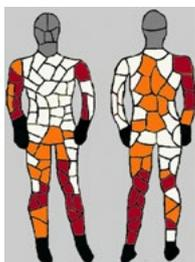
Denne testen produserer et kroppskart som viser prognoser for andre- og tredjegradsforbrenninger og dermed indikerer hvor effektivt et plagg beskytter den som går med det.
